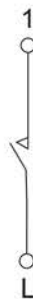
k) выключатель с самовозвратом / momentary contact switch / өзі қайтатын бір пернелі ажыратқыш / intrerupator singură automat cu resetare
