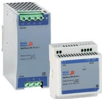
Универсальные однофазные блоки питания OptiPower серий DR, MDR и LRS являются импульсными AC/DC преобразователями напряжения с креплением на DIN-рейку или монтажную плату, обеспечивают питание различных устройств автоматики стабилизированным напряжением постоянного тока 12 В или 24 В и защиту от перегрузки, перенапряжения и короткого замыкания на выходе.
