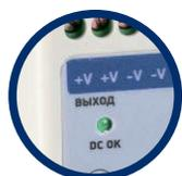
Индикация состояния выходного напряжения
