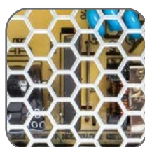
Вентиляционные отверстия для лучшего теплоотвода
