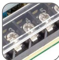
Сдвоенные клеммы питания для удобного подключения
