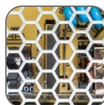
Вентиляционные отверстия для лучшего теплоотвода
