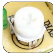
Возможность корректировки выходного напряжения
