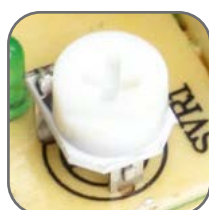
Возможность корректировки выходного напряжения
