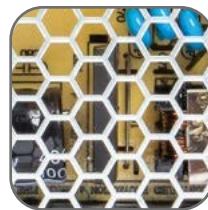
Вентиляционные отверстия для лучшего теплоотвода
