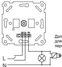
Дополнительный вход L служит для подключения переключателя (см. 6 или 7)
