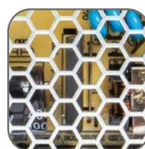
Вентиляционные отверстия для лучшего теплоотвода
