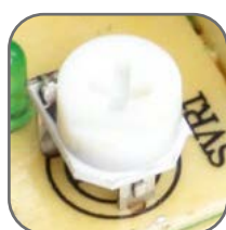
Возможность корректировки выходного напряжения
