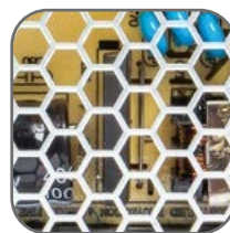
Вентиляционные отверстия для лучшего теплоотвода
