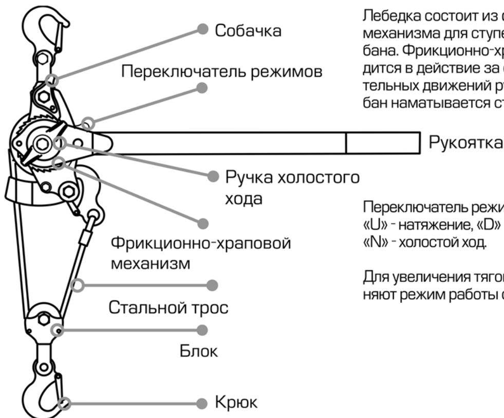
Лебедка состоит из фрикционно-храпового механизма для ступенчатого вращения барабана. Фрикционно-храповый механизм приводится в действие за счет возвратно-поступательных движений рукоятки, при этом на барабан наматывается стальной канат
