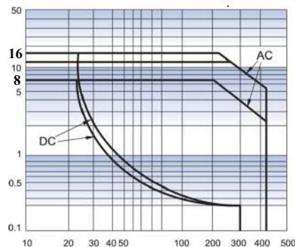
График максимальной коммутируемой нагрузки
