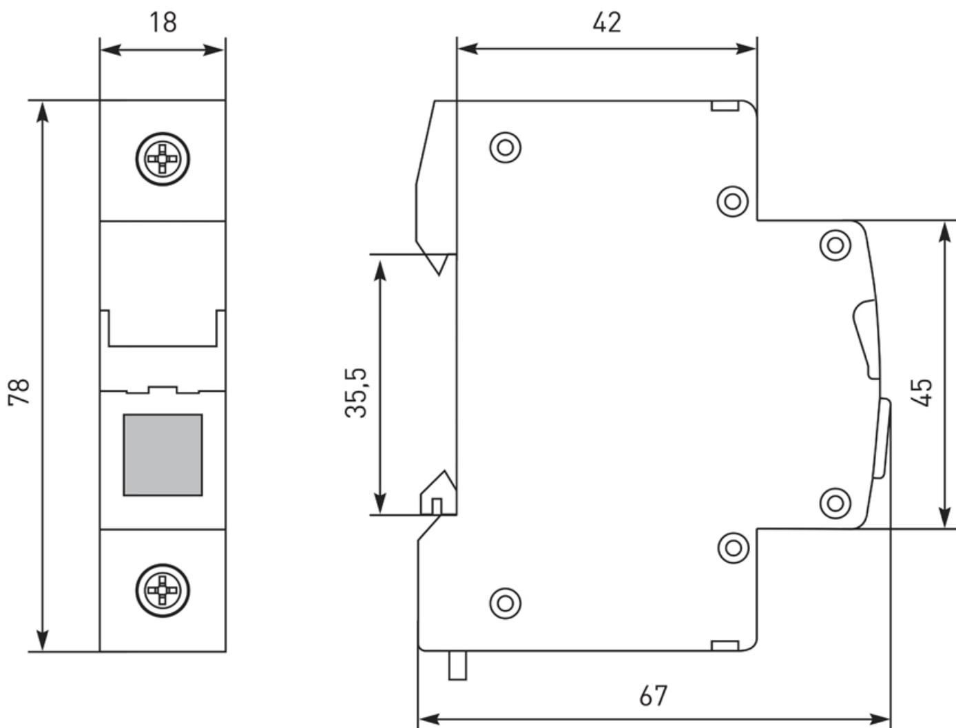
Рисунок 1 – Габаритные размеры сигнальных ламп AV-L
