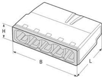
Габаритные размеры клемм в мм.
