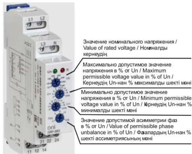
Рисунок 6 – Назначение органов управления реле ORF-06D / Figure 6 – The assignment of ORF-06D relay controls / Сурет 6 – ORF-06D релесінің басқару органдарының мақсаты
