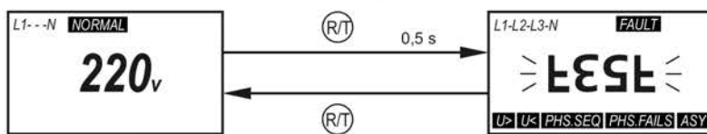
а) Проверка срабатывания реле / Checking relay operation / Реленің іске қосылғанын бақылау
