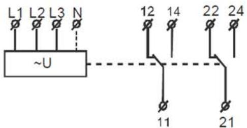
L1, L2, L3 – клеммы подключения питания;
