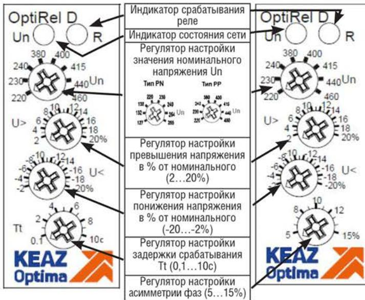
3.2 Настройку номинального, максимального и минимального напряжений, а также асимметрии фаз производить потенциометром.
