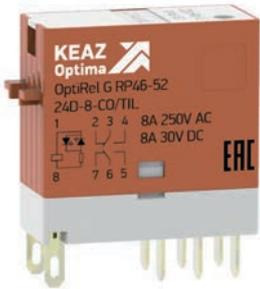
Миниатюрное промышленное реле серии RP46 представляет собой подключаемое миниатюрное реле с двумя силовыми перекидными контактами, контрольной кнопкой, механическим индикатором состояния и светодиодом. Материал контактов — AgSnO<sub>2</sub>. Реле серии RP46 совместимы с розеткой для реле серии RR97.
