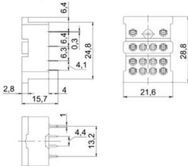
Рисунок Б.1 – Габаритные, установочные и присоединительные размеры розеток OptiRel G RR94-1X
