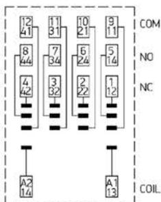
Рисунок В.1 – Принципиальная электрическая схема розеток OptiRel G RR94-54
