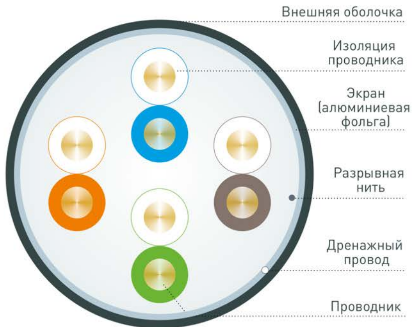
Рис. 3 – Конструкция кабеля F/UTP (количество жил 4x2)
