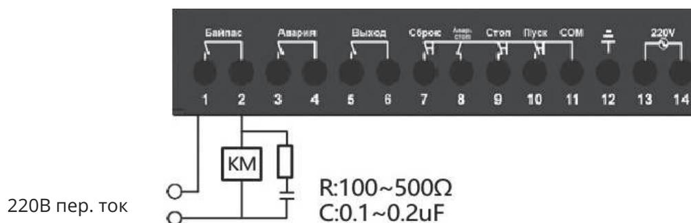
2. Клеммы 3 и 4 – выход реле неисправности изделия.
