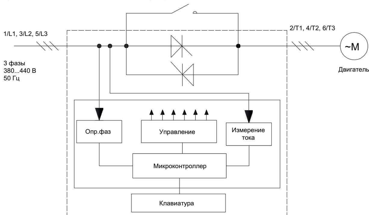
2. Силовая цепь устройства плавного пуска двигателя со встроенным байпасным контактором.
