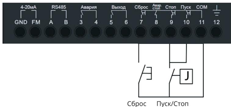
7. Клемма 12 – корпус устройства, для подключения к шине защитного заземления.
