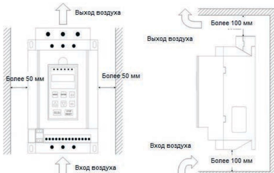
**Свободное пространство при установке УПП со встроенным байпасным контактором**
