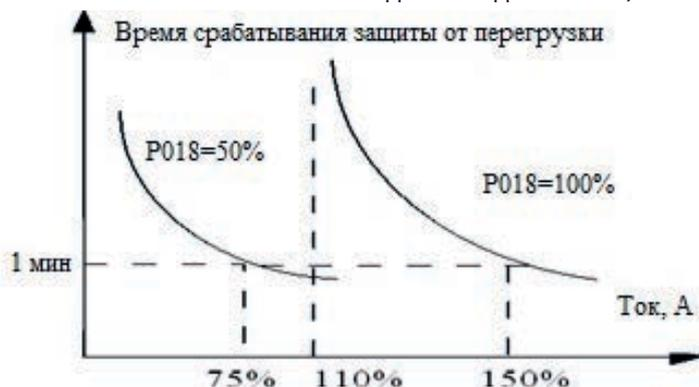
Кривые характеристики защиты от перегрузки показаны на диаграмме ниже (P018=100% и P018=50%). При P018=100% допускается работа при токе, равном 150% от номинального тока изделия, в течение 1 мин. При токе, равном 120% от номинального тока изделия, допускается работа в течение 500 с.
