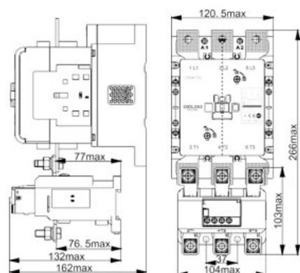
Независимая установка теплового реле MRG-185
