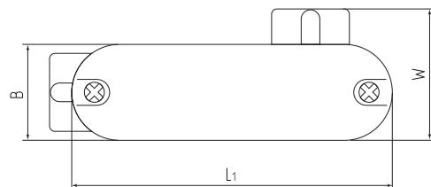
Конструкция коробок распределительных КРВ-Л
