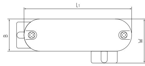
Конструкция коробок распределительных КРВ-П
