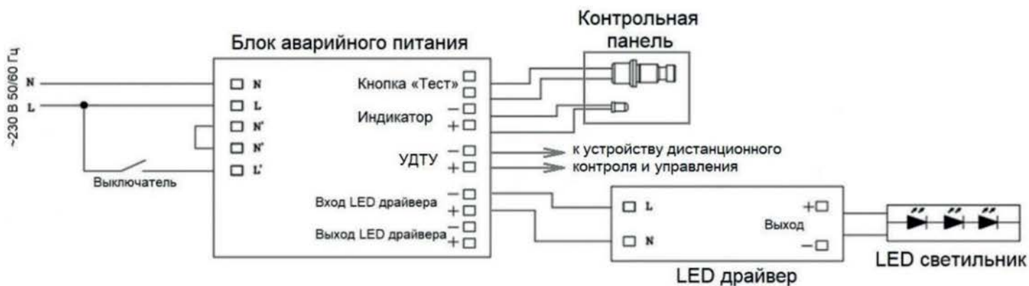
Рисунок 2 – Схема подключения БАП для работы в основном режиме
