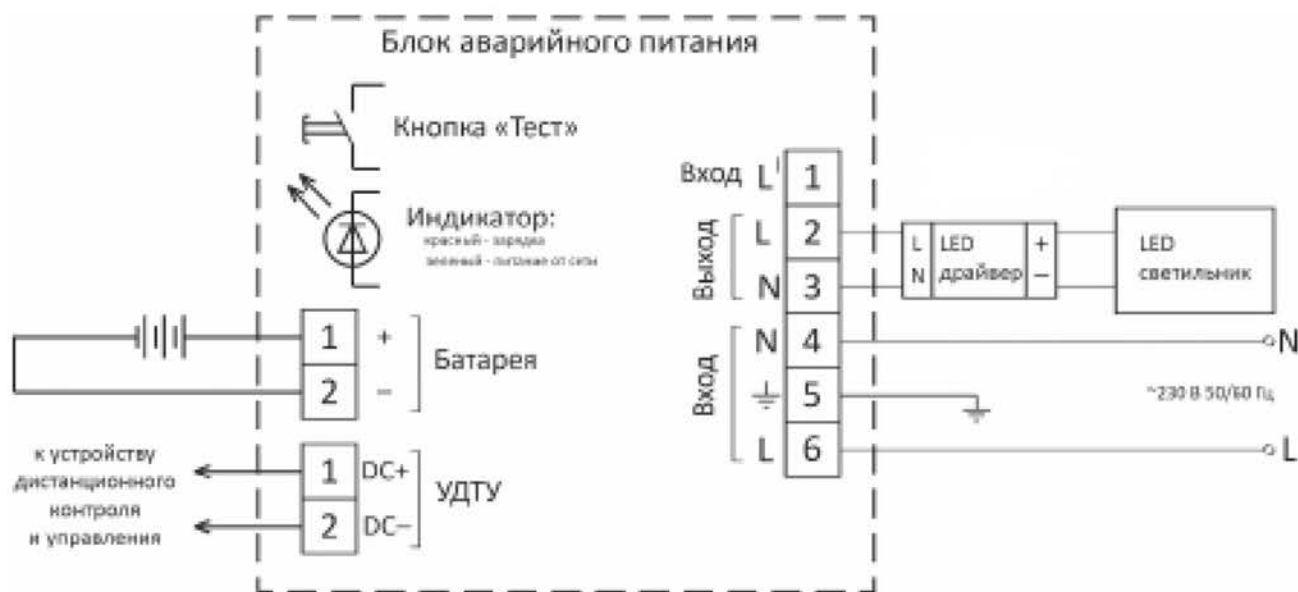
Рисунок 3 – Схема подключения БАП для работы в режиме непостоянного включения
