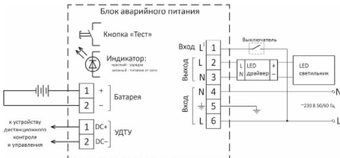
Рисунок 2 – Схема подключения БАП для работы в основном режиме
