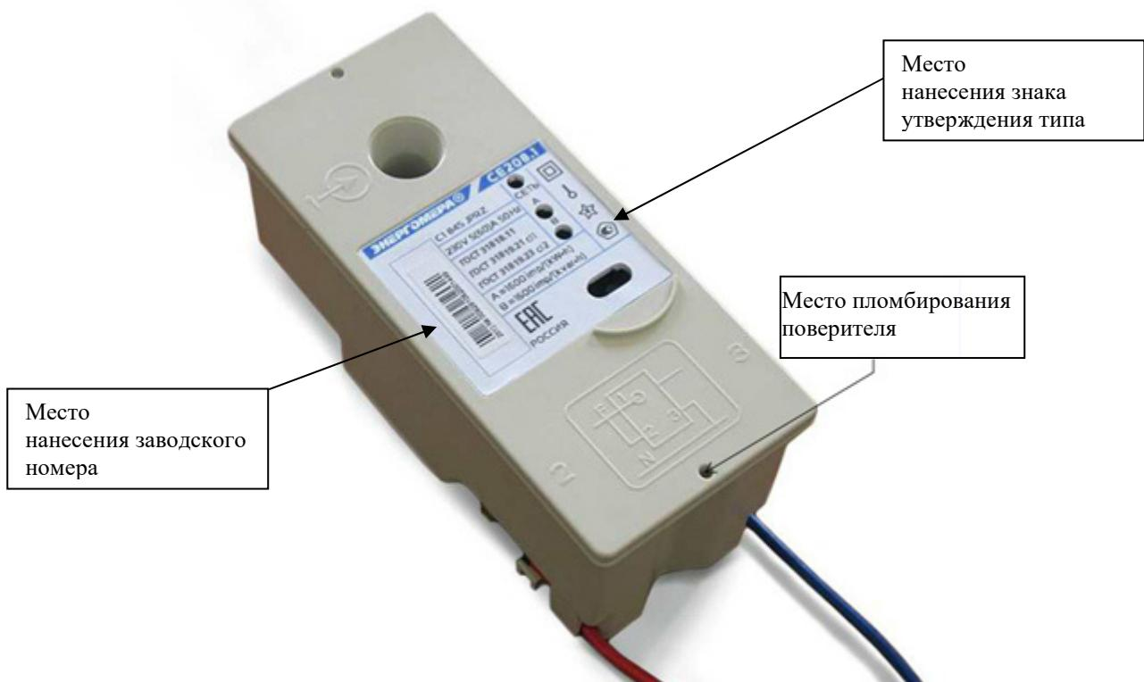
Рисунок 5 – Общий вид счетчика СЕ 208 C1
