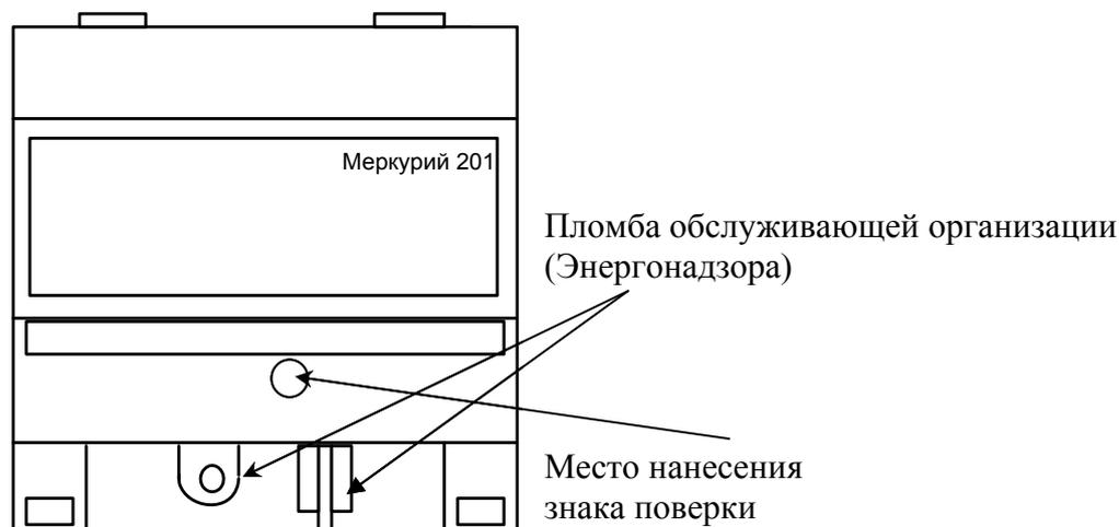
Рисунок 6 - Схема пломбировки от несанкционированного доступа, обозначение места нанесения знака поверки счётчиков «Меркурий 201.1», «Меркурий 201.2», «Меркурий 201.22», «Меркурий 201.3», «Меркурий 201.4», «Меркурий 201.42», «Меркурий 201.5», «Меркурий 201.6»
