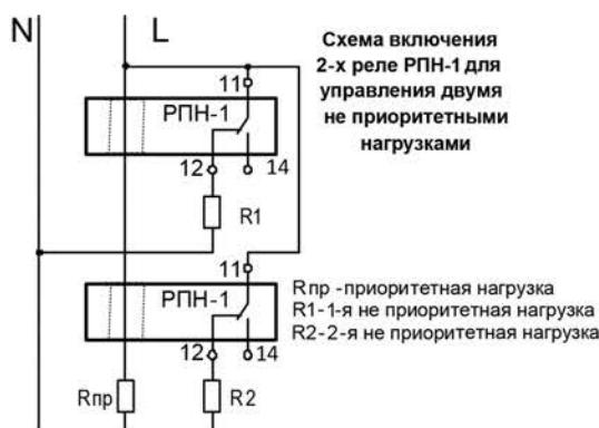
Схема включения 2-х реле РПН-1 для управления двумя не приоритетными нагрузками
