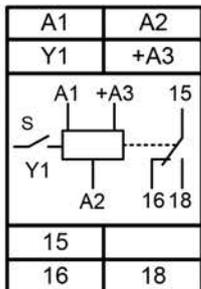
Напряжение питания AC230В подаётся на клеммы «A1» и «A2», ACDC24В на клеммы «+A3» и «A2». Команда внешнего управления подаётся на клемму «Y1» и формируется замыканием сухого контакта «S» между клеммой «Y1» и клеммой «A1» или «+A3».
