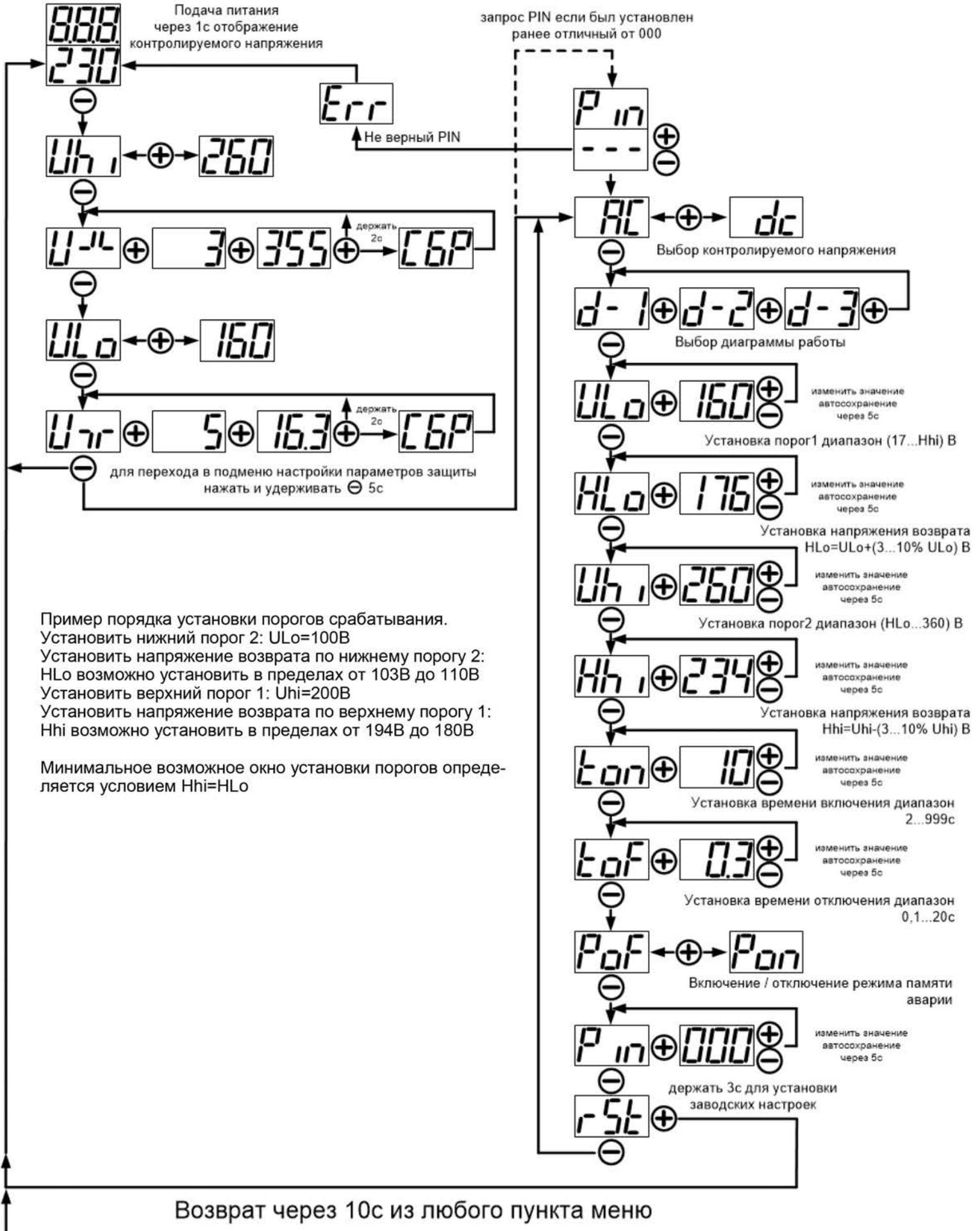
Пример порядка установки порогов срабатывания.
