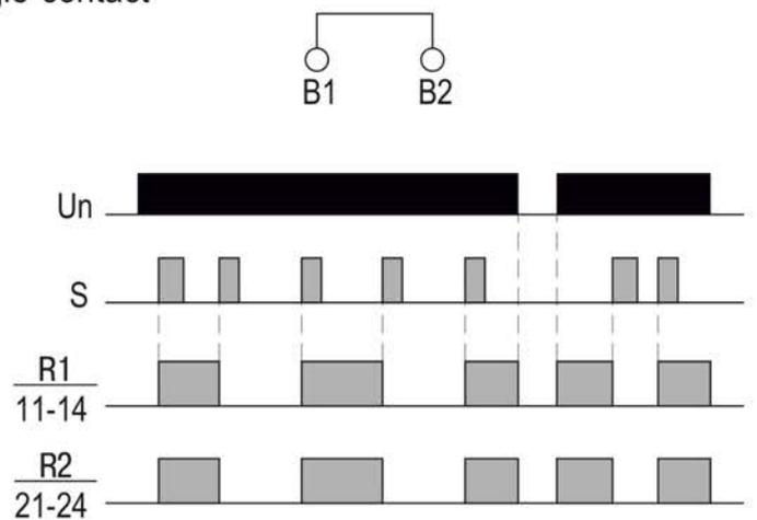
Рисунок 6 – Функциональная диаграмма реле ORM двухконтатные. Режим управления 2 / Figure 6 - Functional diagram of the ORM two-contact relays. Operation mode 2
