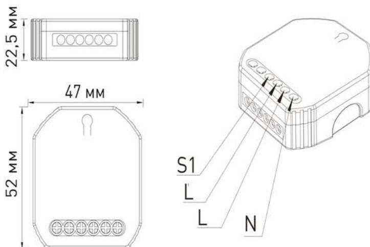
Рисунок 1. Общий вид и габаритные размеры реле
