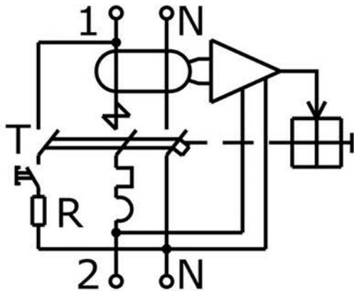
T – устройство эксплуатационного контроля (кнопка «ТЕСТ»)
