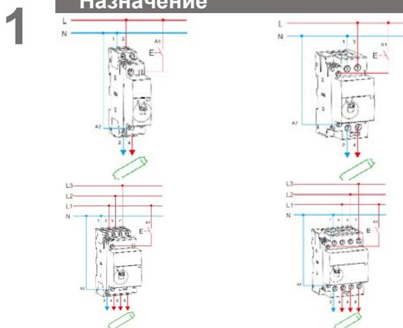
**Модульные контакторы** предназначены для управления нагрузками небольшой мощности, требующими большого количества включений / отключений – инженерное оборудование зданий, насосы, системы вентиляции и т.д.
