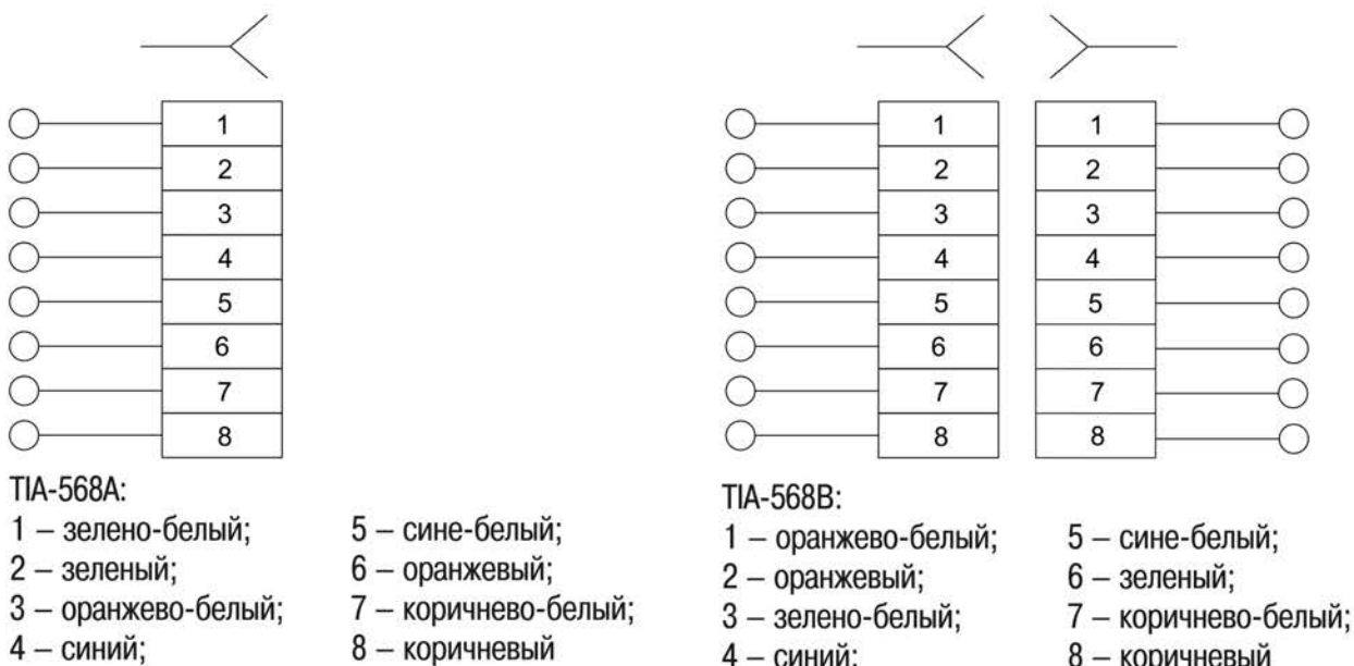
Рисунок 2 – электрическая схема компьютерных розеток РК10-ВБ, РК10-2-ВБ
