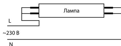
**Внимание!** В светильниках следует применять светодиодные лампы с двухсторонним подключением (см. схему).
