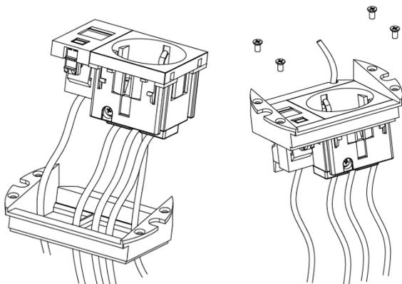
Подсоединить провод заземления к точке заземления на панели крышки и затяните его с помощью винта
