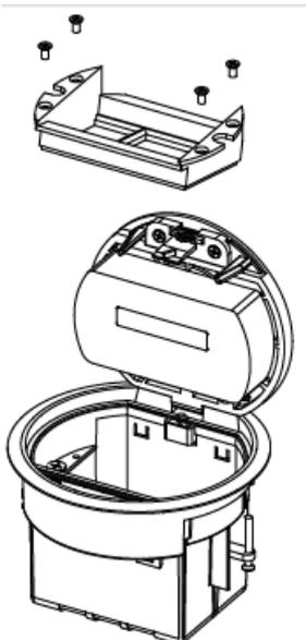
Пропустить провода через отверстия в полу, затем завести их в пластиковую коробку через кабельные выводы
