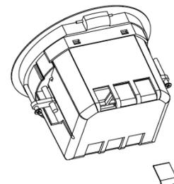
Пропустить провода через отверстия в полу, затем завести их в пластиковую коробку через кабельные выводы
