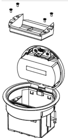
Используя инструмент, удалить заглушку для кабельных выводов
