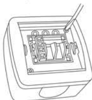
Рисунок 2. Вывернуть два самореза и снять крышку изделия.
