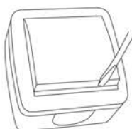
Рисунок 1. Снять клавишу при помощи наконечника плоской отвертки.
