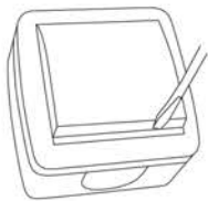
Рисунок 1. Снять клавишу при помощи наконечника плоской отвертки.
