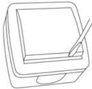
Рисунок 1. Снять клавишу при помощи наконечника плоской отвертки.
