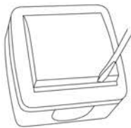
Рисунок 1. Снять клавишу при помощи наконечника плоской отвертки.
