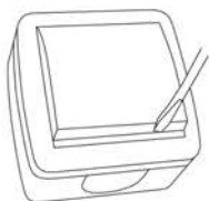
Рисунок 1. Снять клавишу при помощи наконечника плоской отвертки.
