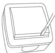
Рисунок 1. Снять клавишу при помощи наконечника плоской отвертки.
