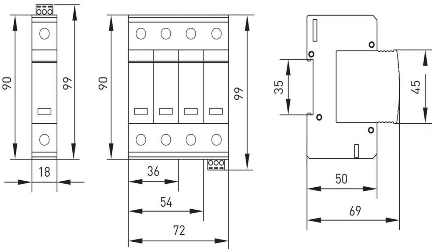
Рис. 2 – Габаритные размеры УЗИП класса Т1+Т2
