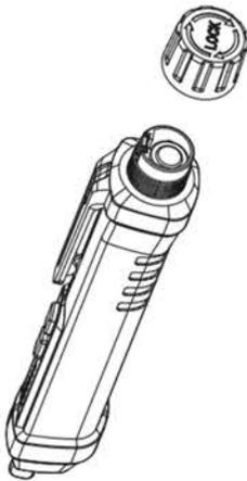
1. Открутите крышку батарейного отсека в задней части детектора.
