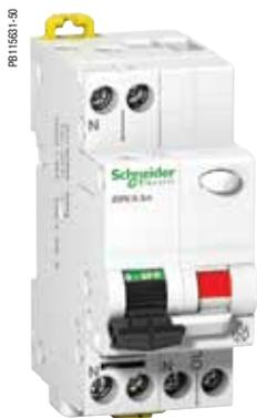
Устройство iDPN N Arc снижает риск пожаров электрического происхождения. Данное устройство, непрерывно анализируя большое количество электрических параметров, обнаруживает появление дуговых разрядов, инициирующих возгорание. Устройство автоматически размыкает защищаемую цепь до появления первых признаков пламени. Устройство iDPN N Arc предназначено только для жилых помещений для защиты цепей с максимальным риском возгорания:
