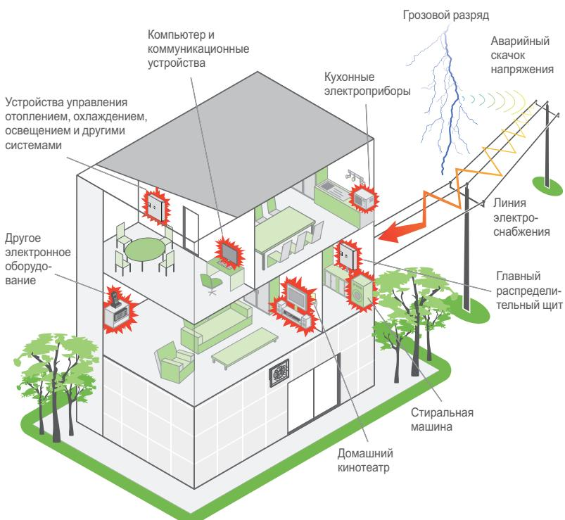
**+** УЗИП многократно защищает от импульсов перенапряжения при токах разряда, которые меньше номинального тока УЗИП.
