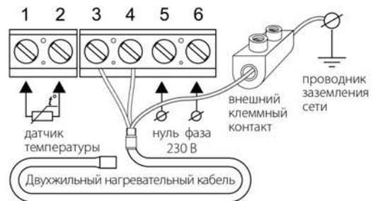
Схема подключения к 3-х проводной электрической сети
