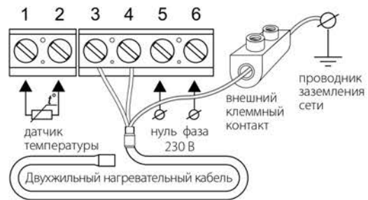
Схема подключения к 3-х проводной электрической сети
