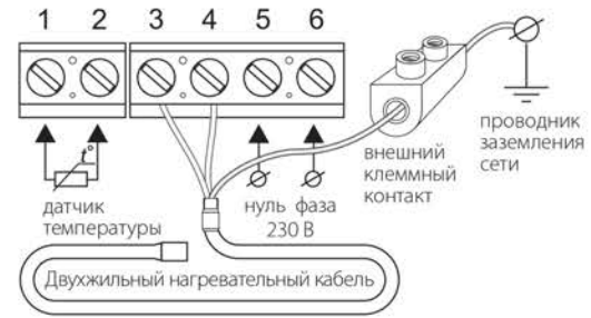
Схема подключения к 3-х проводной электрической сети
