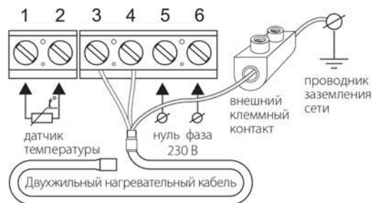
Схема подключения к 3-х проводной электрической сети
