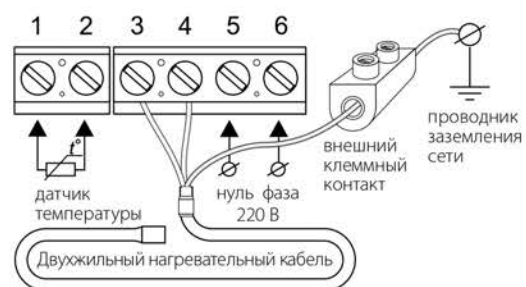
Схема подключения нагревательного кабеля «РУССКОЕ ТЕПЛО» РТ
